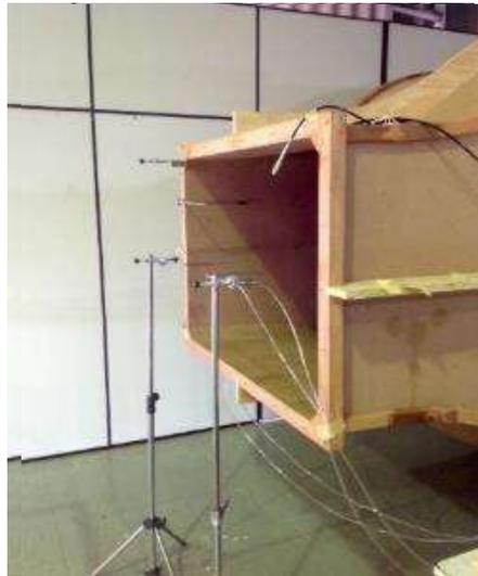
Fotografias nº29 e nº30: Montagens dos sensores medições “1º) Com honeycomb e sem modificações (rev1)”.
